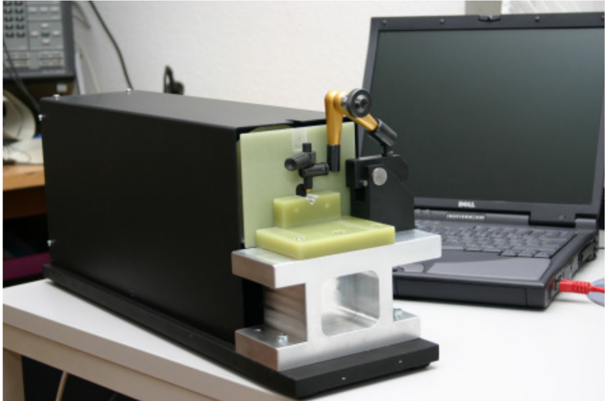
Ansicht einer Prüfvorrichtung (Messweg 100mm)
